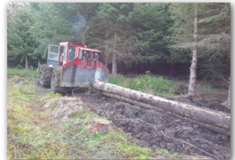
Tracteur forestier en train de débarder des résineux aux Panents (St-Didier-en-Velay)
